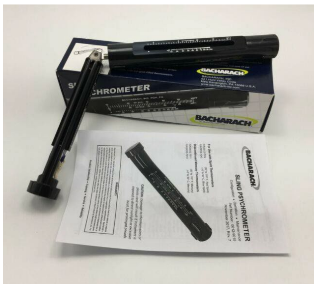
Figur 2. Slyngesykrometer til måling af temperatur og luftfugtighed. Kilde Ebay
